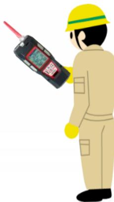
自動車製造の現場では、車体を塗装後に乾燥炉で乾燥させる乾燥工程があります。塗装に使われる塗料には揮発性の有機化合物（VOC）が含まれています。特に、メチルエチルケトン（MEK）は揮発性と引火性が高い物質で、揮発したガスが高濃度になると爆発を起こす可能性があります。また、MEKには毒性もあるため設備からの漏洩には注意が必要です。
