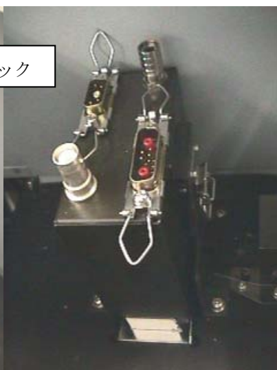
ケーブルとロックを 外された検知器
