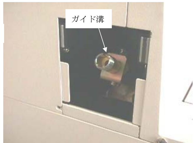
DC1 光ファイバー接続口
