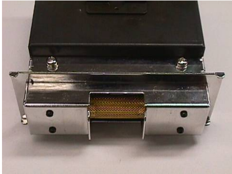
カバー装着前の検知器先端部
