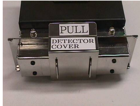
カバー装着後の検知器先端部
