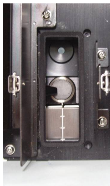
検知器取り外し後の本体
