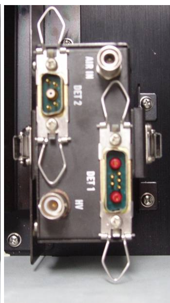
ケーブルとロックを外された検知器
