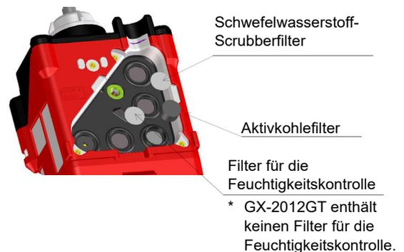
(3) Sensorabdeckung am Hauptgerät befestigen und die drei Schrauben festziehen.
