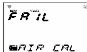
Bei defektem CH<sub>4</sub>-Sensor
