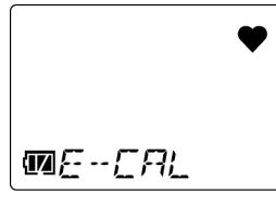
2 AIRボタンを数回押してワンタッチ校正の時間を設定し、POWER/MODEボタンを押す
