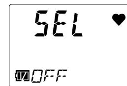
3 AIR ボタンを数回押してコンファームーションビープの動作を選択し、POWER/MODE ボタンを押す
