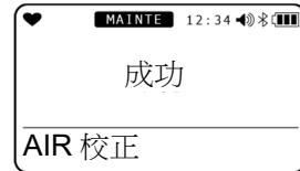
顯示空氣校正後當前的濃度，並返回氣體校正的選項
