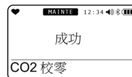
顯示 CO<sub>2</sub> 校零後的濃度，並返回氣體校正的選項畫面。
