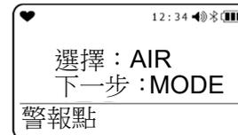
每按 **AIR** 按鍵一次，依序顯示「FULL SCALE」→「WARNING」→「ALARM」→「ALARM H」→「STEL」→「TWA」→「FULL SCALE」→ . . . . .
