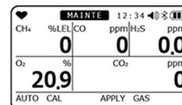
通氣測試及氣體校正結束後，顯示通氣測試結果 (左) 及氣體校正結果 (右)、通氣測試時的讀值、氣體校正後的讀值。
