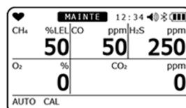
僅日本國內防爆規格時，在自動校正成功後顯示感測器餘力值。
