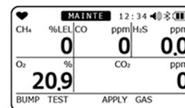
設定為通氣測試失敗後進行氣體校正時，通氣測試若失敗則自動實施氣體校正。
