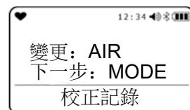
每次按下 **AIR** 按鍵，依序顯示「CH<sub>4</sub>」→「O<sub>2</sub>」→「H<sub>2</sub>S」→「CO」→「CO<sub>2</sub>」→……。
