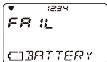
Anomalia de tensão da bateria
