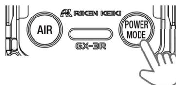
ブザーが“ピッピッピ”と3回鳴り、表示部に「TURN OFF」と表示され、電源が切れます。
