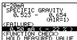
이상 상태(FAILURE) 시 출력값 설정
