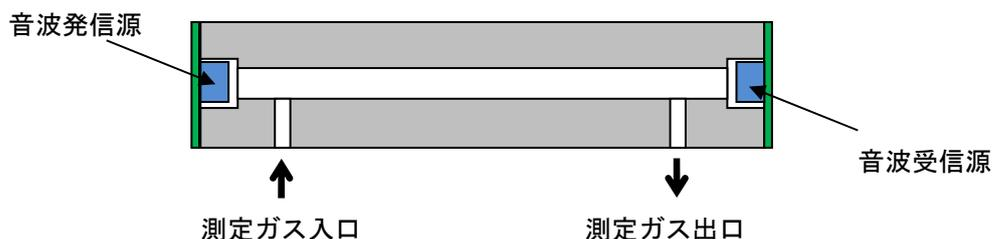
音速センサの模式図を上に表示します。このセンサでは、測定ガスが流れている筒に向かって、音波発信源から音を発し、測定ガス中を伝播して受信源に達するまでの時間  $\tau$  を測定します。
