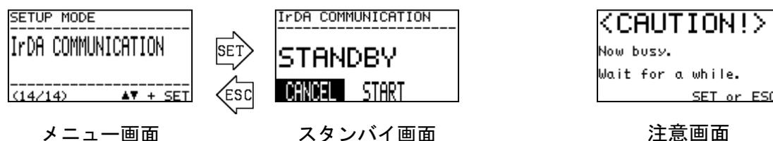
スタンバイ画面の状態、通信機器（GX-2009 TYPE-DL など）を準備します。通信機器にて通信を開始したら、▲▼キーにて START を選択して SET キーを押します。正常に通信が確立できた場合は、自動的にデータ送信画面となり、通信機器からのデータ送信要求に答えます。
