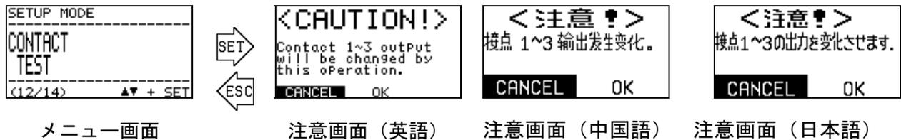
▲▼+SET キーで「OK」が選択されると、テスト信号出力画面に切り替わり、現在の接点状態が表示され、同時に接点のテスト信号が出力されます。
