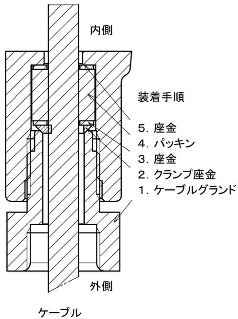
ケーブルグランドのボルトを 40N-m かそれ以上の強さで締め付けて下さい。
