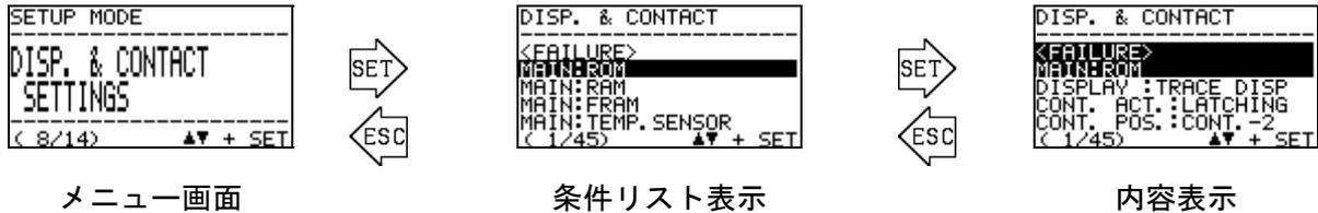
内容表示画面で SET キーを押すと、変更項目が白黒反転表示となります。▲▼キーで動作を選択して SET キーで確定させます。各項目で選択可能な動作は、下表の通りです。
