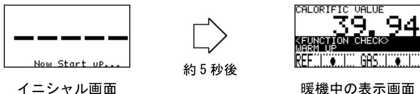
電源投入後15分は『暖機状態』となります。暖機状態は『機能確認 (FUNCTION CHECK)』というカテゴリに分類され、標準設定のOHC-800では測定は行われずに4-20mA出力は、お客さまご指定の設定値が出力されます。
