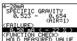
異常状態（FAILURE）時の出力値の設定
