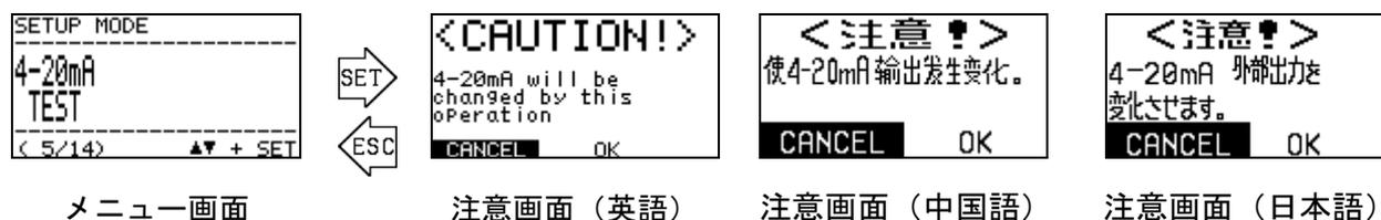
▲▼+SET キーで「OK」が選択されると、4mA のテスト信号が出力されます。
