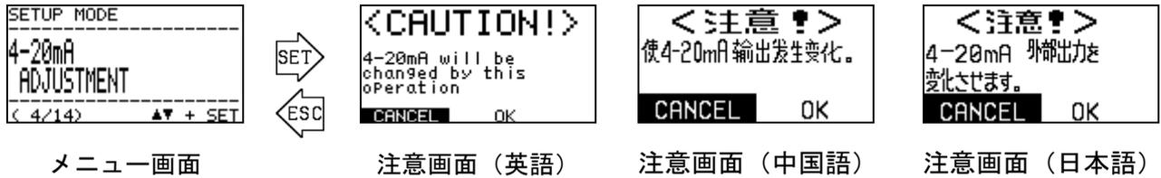
▲▼+SET キーで「OK」が選択されると、テスト信号出力画面に切り替わり、4mA または、20mA のテスト信号が出力されます。
