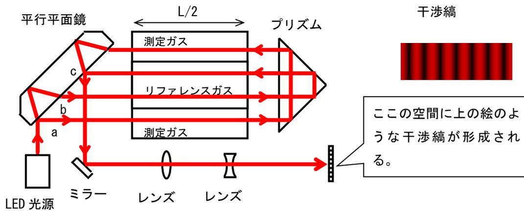
光波センサに用いている干渉計の模式図を上を示します。この干渉計は、測定ガスとリファレンスガスの「屈折率の差」に比例して移動する「干渉縞」を形成します。
