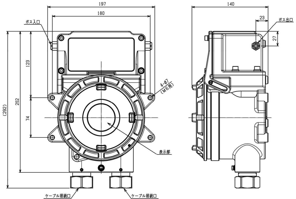
接点・伝送用 (SD-D58-AC-GH/ SD-D58-AC-Z-GH)
