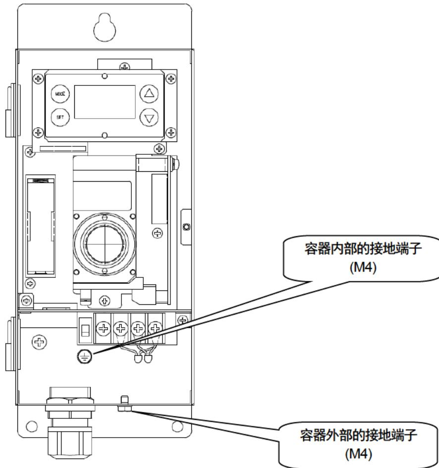
为了仪器稳定动作与安全, 请务必进行接地。另外, 接地线绝对不要连接气体管。请进行 D 种接地施工 (接地电阻 100Ω 以下)。
