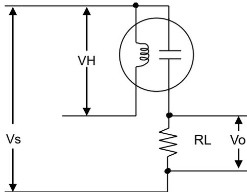
RL: Resistência de carga, Vo: Voltagem de saída
