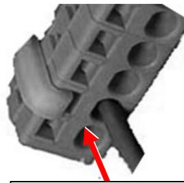
Mantendo a alavanca para baixo, insira o fio no orifício do fio (redondo) até que atinja o ponto mais profundo. Quando se libera a alavanca o fio é fixado.
