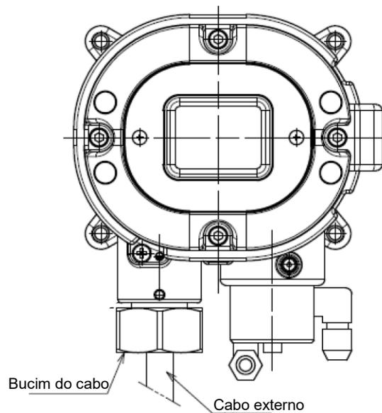
Conforme mostrado na figura abaixo, ligue as peças pela ordem seguinte: buçim do cabo, arruela excêntrica, arruela e vedante de borracha no cabo e, em seguida, conecte o cabo à unidade principal e depois aparafuse o buçim do cabo para apertar o vedante de borracha.
