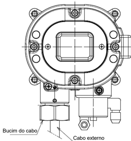
Conforme mostrado na figura abaixo, ligue as peças pela ordem seguinte: buçim do cabo, arruela excêntrica, arruela e vedante de borracha no cabo e, em seguida, conecte o cabo à unidade principal e depois aparafuse o buçim do cabo para apertar o vedante de borracha.
