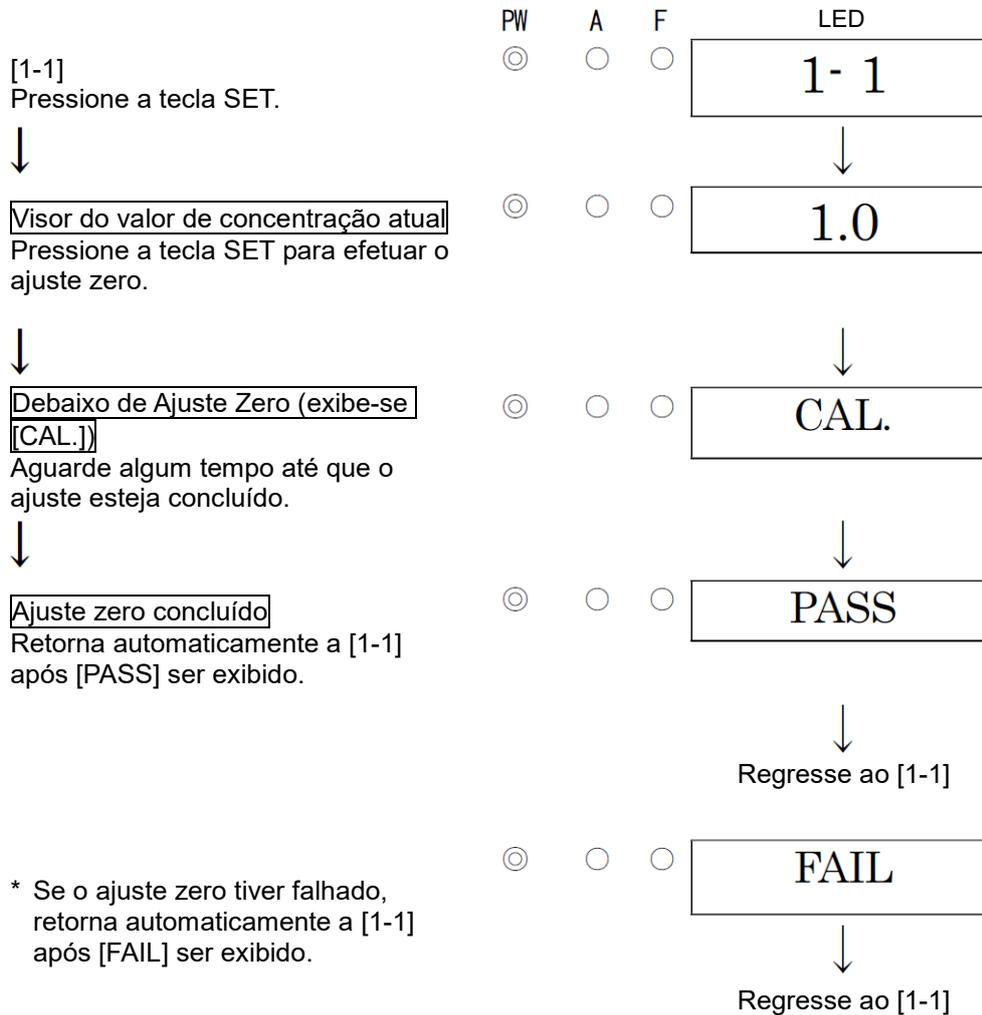
\* Se o ajuste zero tiver falhado, retorna automaticamente a [1-1] após [FAIL] ser exibido.
