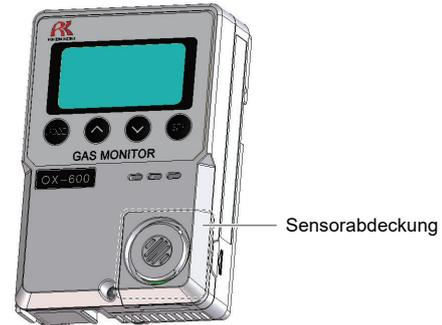
Stecken Sie eine Münze gerade in den vertieften Bereich unten rechts vom Warngerät, um die Sensorabdeckung nach oben zu bewegen.
