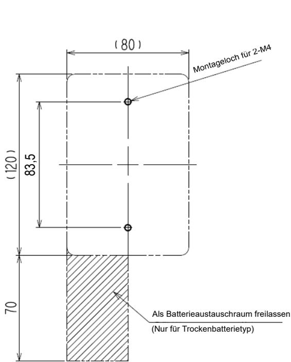
Maßzeichnung für die Installation (ohne Installationsplatte)
