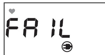
Wenn „FAIL“ angezeigt wird, führen Sie die Bereichseinstellung erneut durch.
