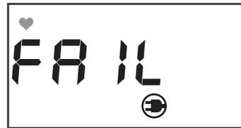
Wenn „FAIL“ angezeigt wird, führen Sie die Nulleinstellung erneut durch.
