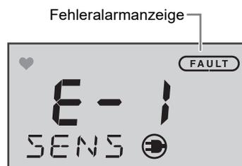
Nachdem das Warngerät erfolgreich aus dem Fehlerzustand zurückgeholt wurde, setzt es den Betrieb nach dem Einschalten (anfängliches Löschen) direkt wieder fort.
