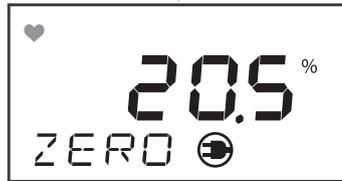
Führen Sie ein N2-Gas (99,5 % oder mehr) am Sensor für drei Minuten zu.
