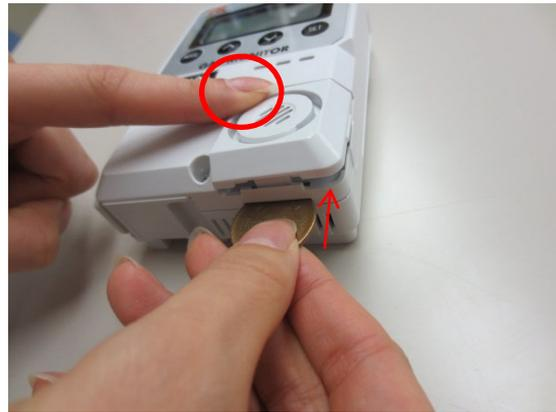
Entfernen Sie die Sensorabdeckung, um den Sensor zu prüfen.
