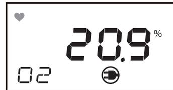
Das Warngerät befindet sich im Messzustand.
